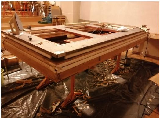
Die Orgel in Rheinhausen hat durch einen Wasserschaden und durch den Zahn der Zeit leider gelitten. An der Klimaanlage einer Handy-Sende anlage im Kirchturm gab es einen Schaden, so dass Kondenswasser in den Maschinenraum der Orgel eingedrungen ist. Vor allem der Blasebalg hat hierbei Schaden genommen. Alle Ecken und Kanten des Blasebalgs müssen neu mit Leder verklebt werden. Auch alle Holzflächen werden neu
